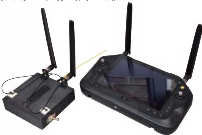
有線・無線中継システム
